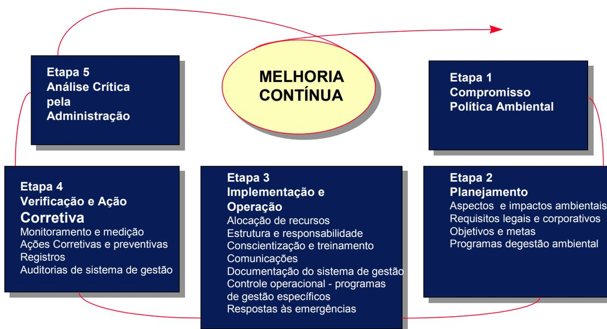
**Figura 02** – Modelo de implantação de um SGA
